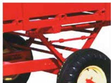
El modelo VFN 5000 incorpora exclusivo sistema de regulación que permite ajustar la altura de descarga de acuerdo con el comedero.
